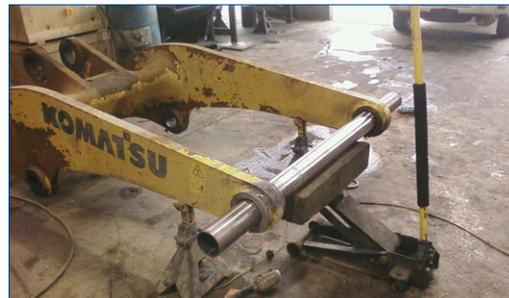
Eje instalado de manera provisoria para mantener la alineación
