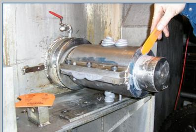
Para este método de reparación, se deben fabricar moldes adecuados de materiales rígidos con separación longitudinal. Deberán ser de una longitud adecuada de modo que la reparación quede en la parte media del molde, y éste apoyado en las secciones sin daños del eje. Además, se deben dejar agujeros de ventilación y, donde se utilicen técnicas de inyección, bocas de inyección en puntos estratégicos.
