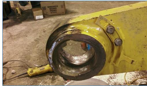
Carcasa de buje y perno dañada
