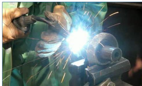
Reparación convencional del eje por soldadura
