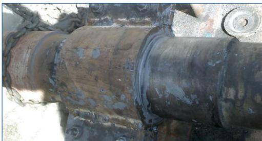
Belzona aplicado, molde colocado
