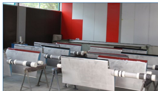
Protección a largo plazo contra la erosión-corrosión del borde delantero
