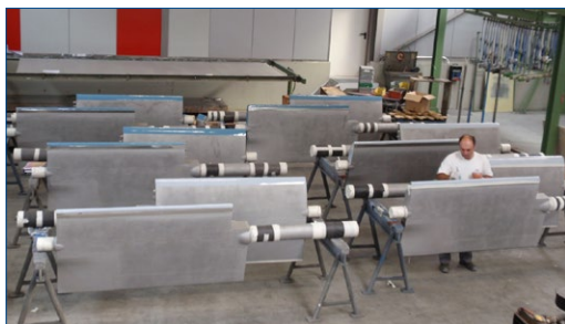
Álabes directrices después del granallado y la aplicación inicial
