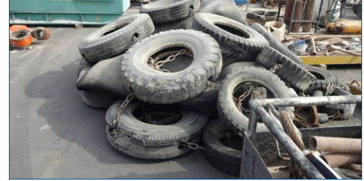
Inspección inicial de la defensa desinflada
