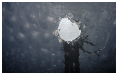
Ampollado del recubrimiento con baja densidad de reticulado
