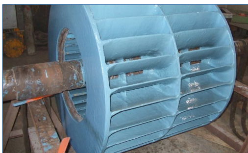
Bomba de vacío protegida contra la corrosión
