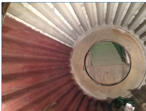
Revestimiento resistente a la abrasión en la descortezadora
