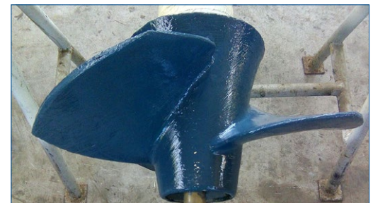
Vueltos a recubrir para servicio futuro en lodos
