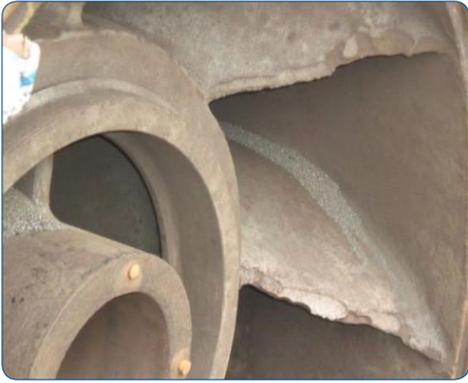
áreas de flujo de fluido incluyendo los rodetes y difusores. Este revestimiento, que se utiliza para mejorar la eficacia, ha demostrado lograr un incremento de hasta el 5% cuando se revisten bombas nuevas. El exterior de la bomba principal se revistió con dos capas de 5811 (Immersion Grade) para proporcionar una protección a largo plazo en condiciones de inmersión.
