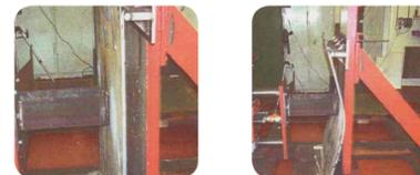
La placa de compuesto Belzona fue capaz de soportar casi el doble de la carga estática antes de sufrir una deformación plástica comparado a una placa de 8mm nominal.
