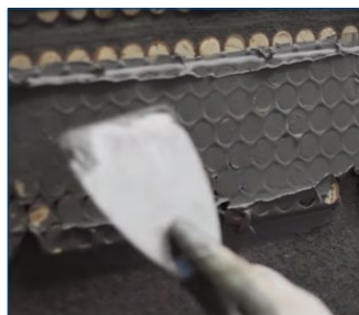
Corchos insertados y reconstrucción en proceso
