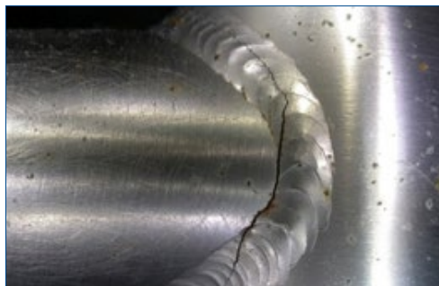
Fig. 2: Agrietamiento por estrés en una soldadura
