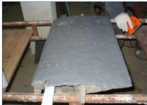
Álabe después de la reconstrucción con Belzona 1111 (Super Metal)
