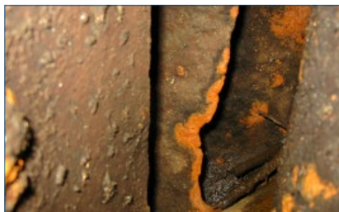
Fig. 2: Rodete de turbina deteriorado
