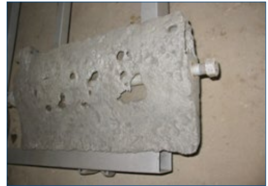
Álabe después de la limpieza con granalla
