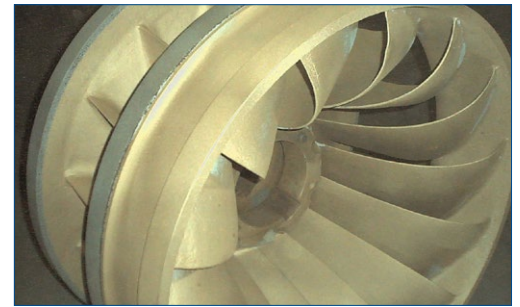
Turbina Francis después de la preparación con granallado abrasivo
