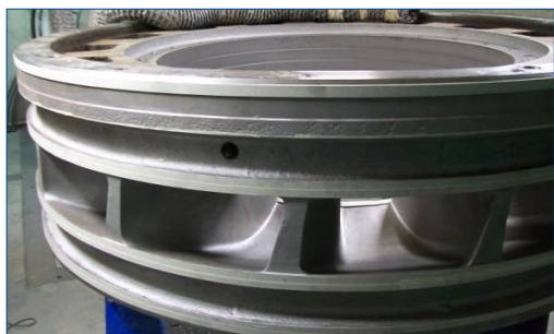
Rodete limpiado con granalla antes de la aplicación
