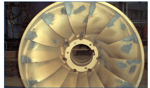
Aplicación de Belzona 1341 (Supermetalgilde) en el rodete en proceso
