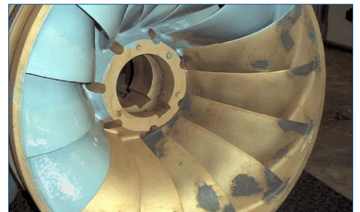
Turbina después de la reconstrucción con un material en pasta para rellenar áreas con daños por erosión
