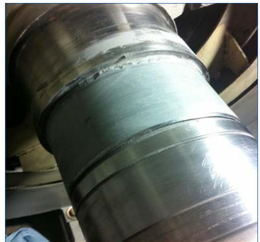
El eje después de la reparación
