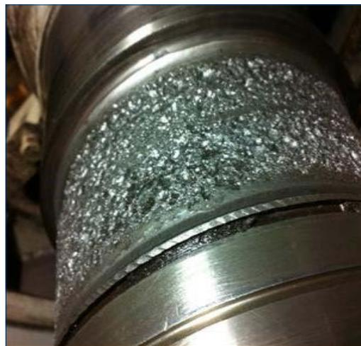
El eje corroído antes de la reparación
