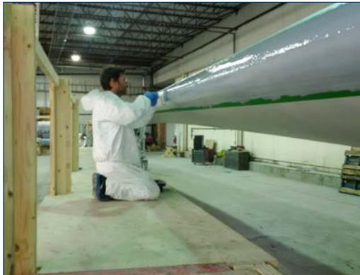
Belzona aplicado con rodillo en el borde delantero
