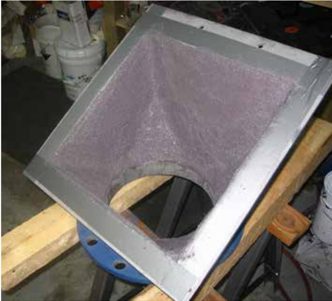
Belzona 1812 (Ceramic Carbide FP) es un recubrimiento de dos componentes para reparación y protección de superficies expuestas al ataque abrasivo.
