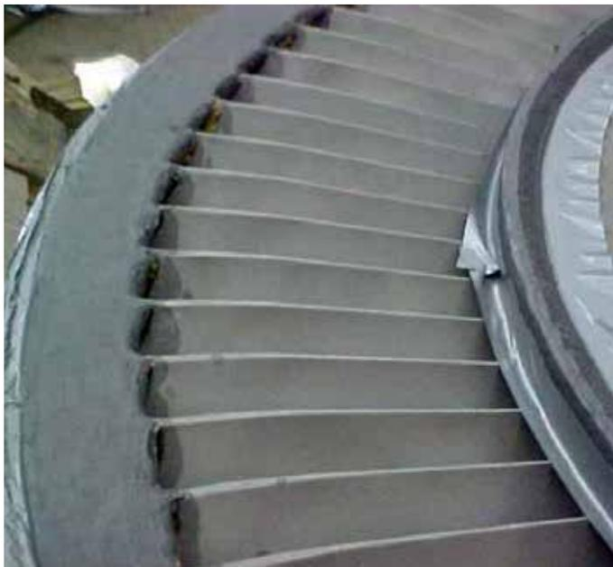
Belzona 1511 (Super HT-Metal) es un sistema en pasta resistente a altas temperaturas para la reconstrucción de equipos dañados por erosión-corrosión. Este material también puede utilizarse como adhesivo estructural de alta resistencia o para la nivelación y alineación de soportes de carga irregulares.
