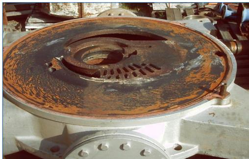
Daño por erosión-corrosión en la placa de orificios
