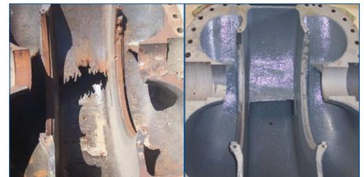
Efectos típicos de la erosión-corrosión en el tajamar de una bomba centrífuga
