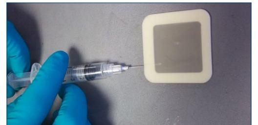
La inspección a fondo de la contaminación por sal (incluye medición de concentración de cloruro) asegura una preparación óptima de la superficie
