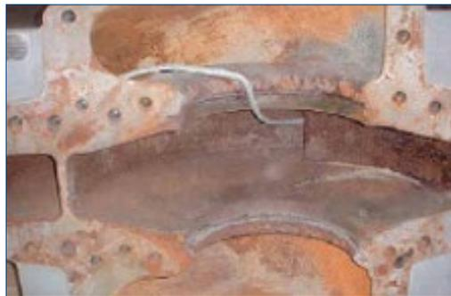
Bomba corroída y dañada por cavitación
