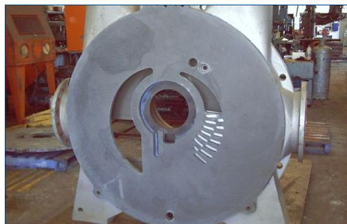
Placa de orificios reparada con Belzona 1111
