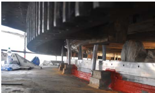
Vista del asiento del cojinete asegurado
